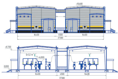
Закрытое распределительное устройство ЗРУ-СЭЩ 110 кВ
